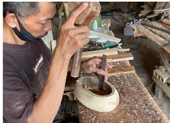
Gambar 8. Proses produksi struktur kayu jati dengan teknik pahat. (Sumber: Dokumentasi pribadi)
