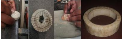
Gambar 13. Proses Pembuatan Bagian Kepala Jam Tangan
