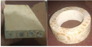
Gambar 7. Papan Bonggol Jagung Mix Material Bamboo, Hasil Hasil CNC Lingkaran Cincin Bonggol Jagung Mix Material Bambu
