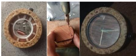
Gambar 15. Proses Perakitan Bagian-Bagian Jam Tangan
