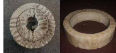
Gambar 10. Hasil Dari Amplas Mesin Bagian Lingkaran Luar, Hasil Dari Scroll Saw Bagian Lingkaran Dalam
