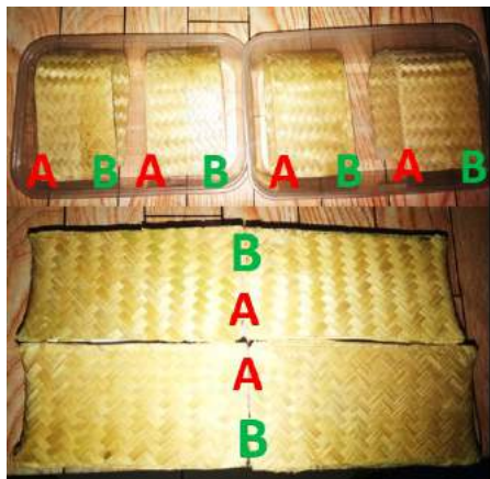
Material sebelum diuji (A : tidak berpelapis B: berpelapis)
