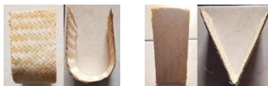
(a) Hasil 5 lapis dengan 100% lem cetakan lengkung
