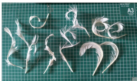
Gambar 7 Hasil eksplorasi material menggunakan alat bantu catokan, heat gun dan setrika. Sumber : Penulis
