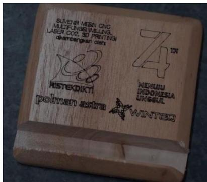
Gambar 9 Stand HP hasil milling dan laser
