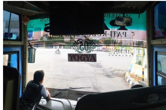
Gambar 5. Kaca depan tanpa sekat kaca pada Bus model Jetbus HD (A1) (Sumber: Dok. Gilang Tirta Kurnia, 2020)
