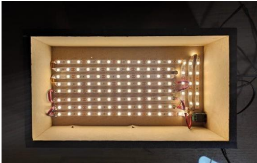
Gambar 15, 16 dan 17 Bagian dalam base yang dijadikan sebagai tempat penyimpanan ketika kosong, terisi dengan modul dan kabel, serta saat lampu dinyalakan. (Sumber: Dokumen Pribadi, 2020)
