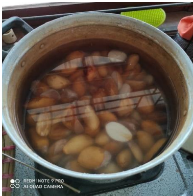
Gambar 1 Pembersihan material tahap kedua dengan cara direbus untuk menghilangkan kandungan getah pada material. (Sumber: Dokumen Pribadi, 2020)
