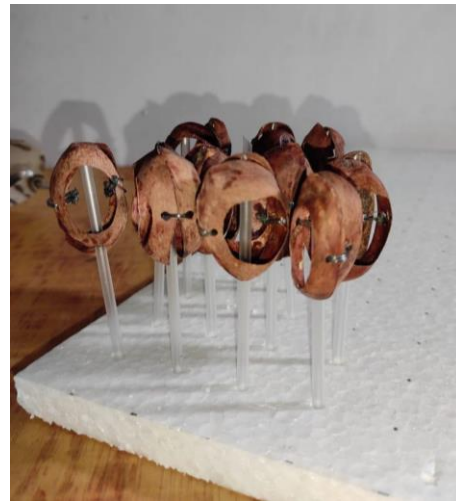
Gambar 14 Simulasi yang dilakukan ketika modul bersama media perantara berupa sedotan air mineral sedang ditancapkan ke styrofoam. Simulasi ini dilakukan untuk memperkirakan keadaan sebenarnya ketika modul dipasangkan ke bahan asli base berupa papan MDF.
