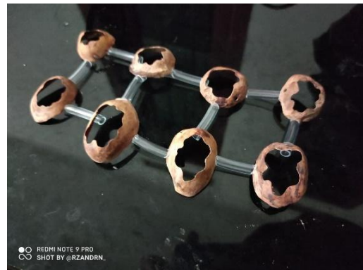
Gambar 10 Rangkaian modul yang dibuat menggunakan selang aquarium.
