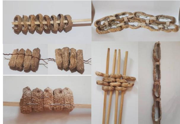
Gambar 3 Metode penyambungan modul (a) Modul ditusuk oleh bilah sumpit, (b) modul diikat dengan benang kasar, (c) Modul dililit oleh kawat, (d) Modul dijahit oleh benang layangan, (e) Modul diheker ke bilah sumpit, (f) Sumpit dimasukkan ke rongga modul, (g) Modul ditusuk oleh lidi.
